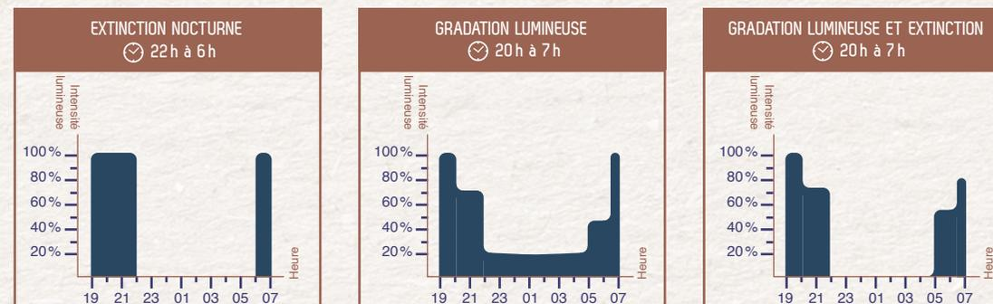
On dit souvent que la gradation lumineuse n'est possible qu'avec la technologie LED. En réalité, les sources à décharge type SHP (Sodium Haute Pression) et même IM (Iodures Métalliques) supportent la gradation lumineuse, mais dans une moindre mesure que la LED (jusqu'à -30% environ). L'extinction est possible pour tous les types d'ampoule et nécessite l'installation d'horloge astronomique.
